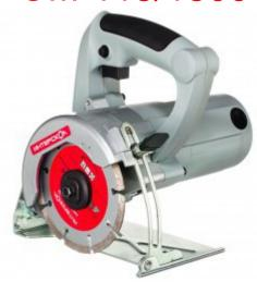
Отрезная машинка - алмазная пила - предназначена для сухой резки различных отделочных материалов – керамической плитки; керамогранита; облицовочной плитки из натурального камня – мрамора, гранита, песчаника и других декоративных видов камня; тротуарной плитки, черепицы и прочих материалов, нарезки канавок для улучшения адгезии строительных растворов.
