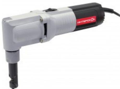
Ножницы электрические вырубные предназначены для прямой и фигурной резки листового материала (профнастила и металлочерепицы) толщиной до 1,2 мм. Принцип действия основывается на вырезании пуансоном за каждый ход небольшого полукруга материала.
